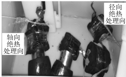
图7 做绝热处理的元件 Fig. 7 Element for adiabatic treatment
